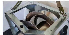
Montage d'œillets de levage aux emplacements dédiés
